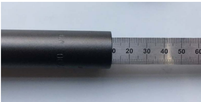
Die Distanz Aussenkante Lenker - Akku messen
