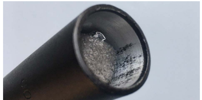
Akku des LightSKIN Lenkers mit Schaumstoffummantelung
