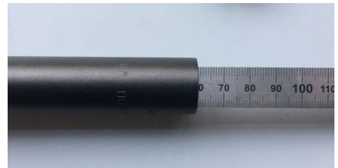
Den Akku vorsichtig weiter in den Lenker schieben und Einschubtiefe kontrollieren, bevor der Lenker gekürzt wird!
